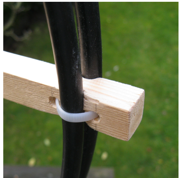
Close-up bevestiging RG-213 aan de dwarslatjes
