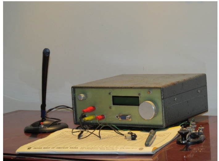
Prototype van de Minima, voorzien van microfoon (links) en seinsleutel (rechts)
